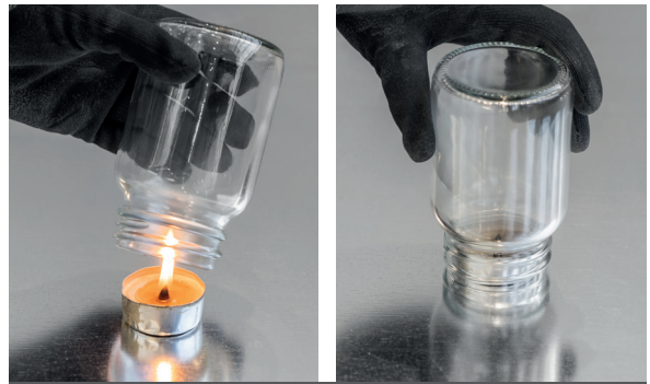
Brennende Kerze mit Glas abdecken. Darauf hinweisen, dass die Flamme langsam kleiner wird, bevor sie erlischt. Die Kerze erlischt, da die Luftzufuhr verhindert und der Sauerstoff verbraucht ist.
